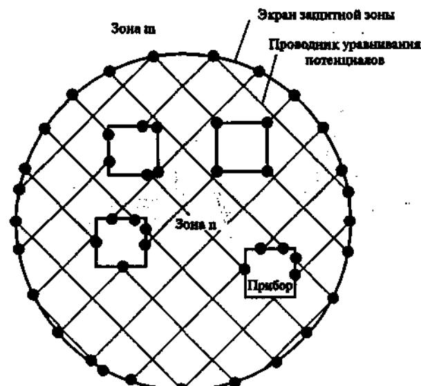
Рис. 4.5. Сетчатое выполнение системы уравнивания потенциалов
