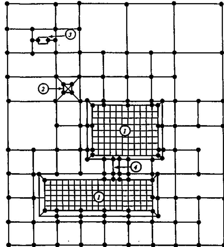
Рис. 4.8. Сетчатое заземляющее устройство производственных сооружений:
