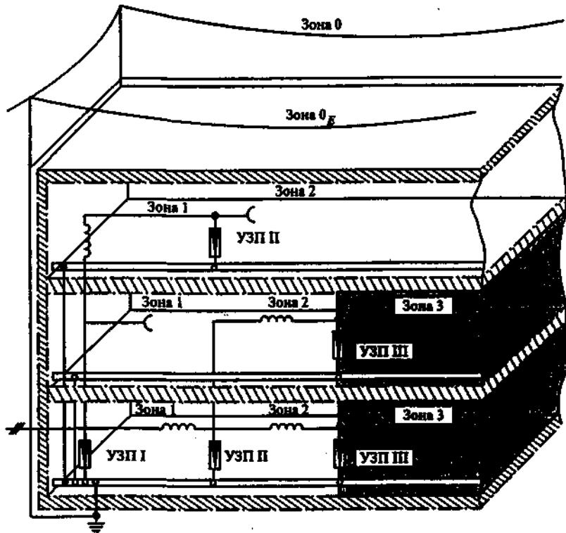
Рис. 4.9. Пример установки УЗП в здании
