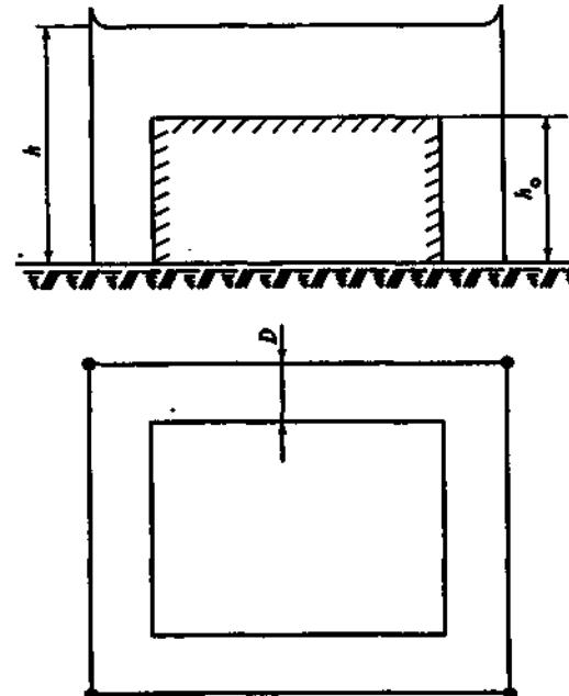
Рис. 3.5. Зона защиты замкнутого тросового молниепропускника
