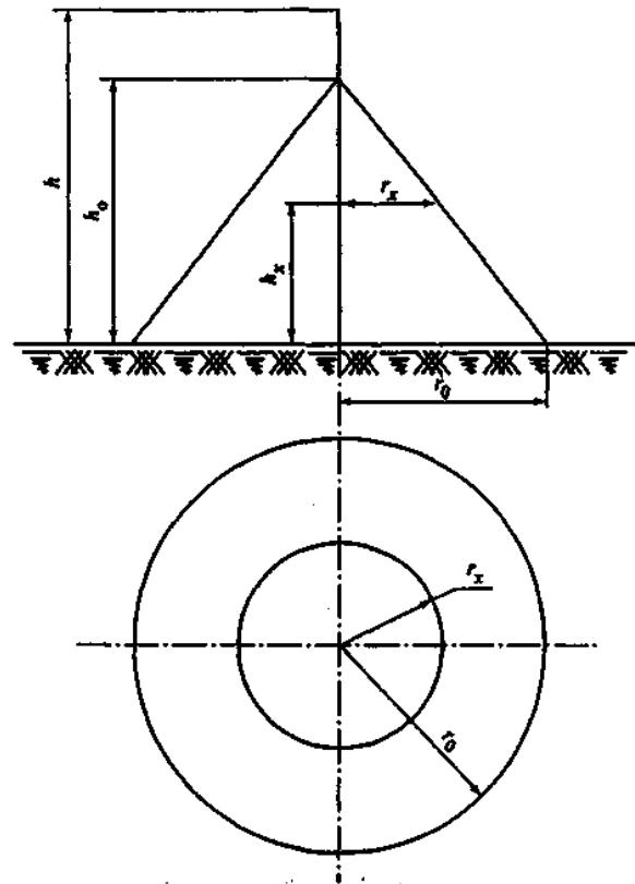
Рис. 3.1. Зона защиты одиночного стержневого молниеотвода определяются двумя параметрами: высотой конуса  $h_0$  и радиусом конуса уровне земли  $r_0$ .
