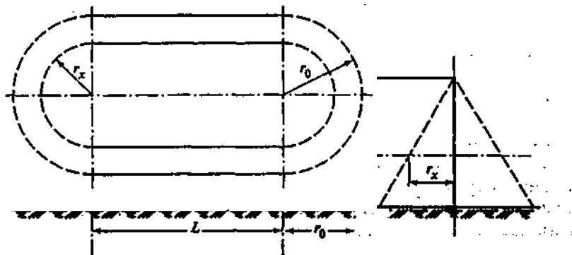
Рис. 3.2. Зона защиты одиночного тросового молниеотвода
