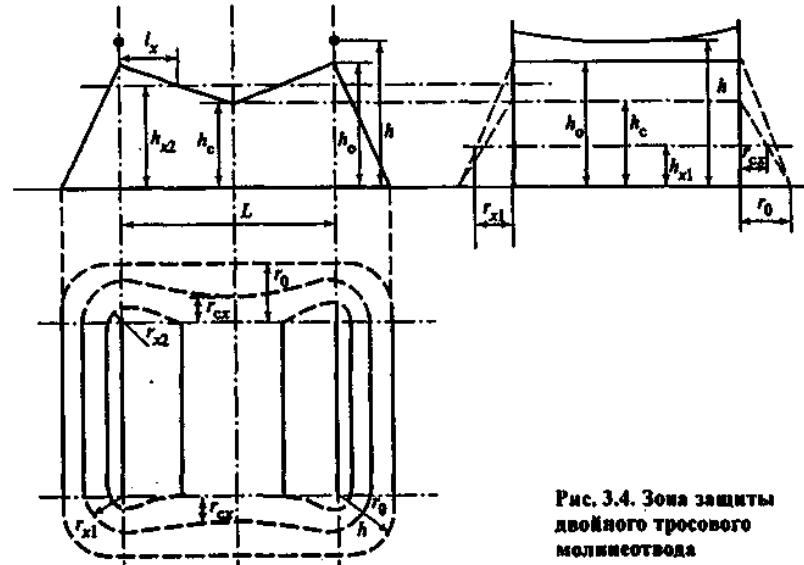
Рис. 3.4. Зона защиты двойного тросового молниеотвода
